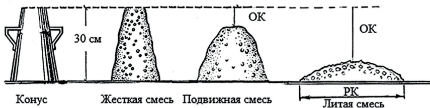
Рис 1.1. Определение вида и подвижности бетонной смеси при помощи стандартного конуса [3]
