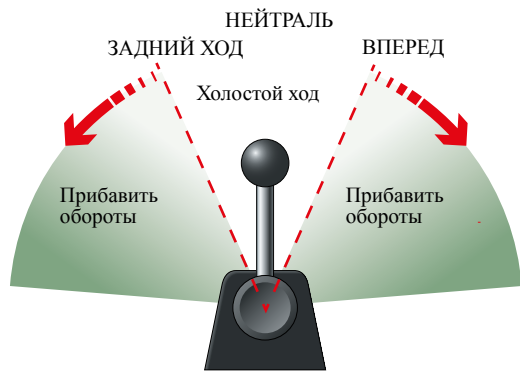
Рис. 3. Комбинированный рычаг управления газом и реверсом
