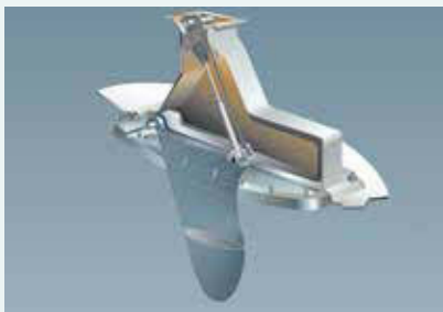
Поворотный шверт Southerly с гидравлическим приводом.
