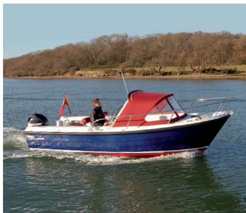
Глиссирующий катер в медленном водоизмещающем режиме.
