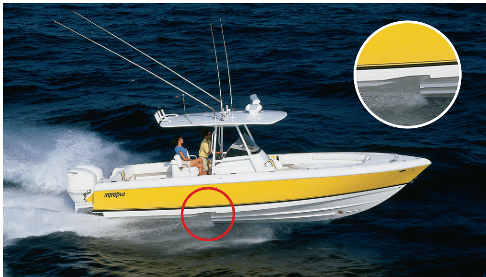
Intrepid - реданированный катер для спортивной рыбалки. Подсос воздуха под корму лодки, позволяет уменьшить смоченную поверхность и сопротивление.
