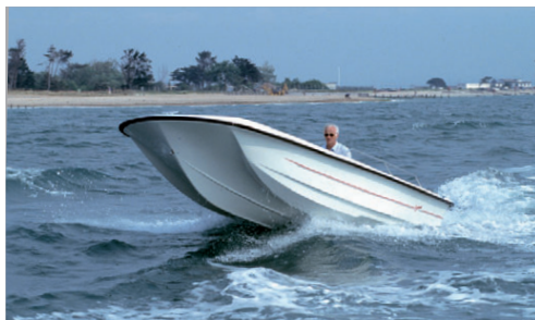
Непотопляемая лодка-дори с обводами «кафедрал».
