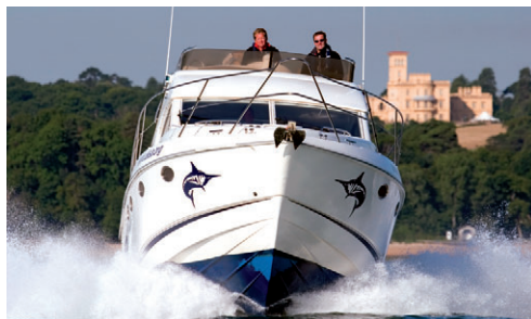
Корпус с «глубоким V» в глиссирующем режиме.
