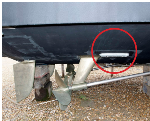
Цинковый анод, установленный в районе выхода валопинии с бронзовым винтом и пера руля защищает их от электролитической коррозии
