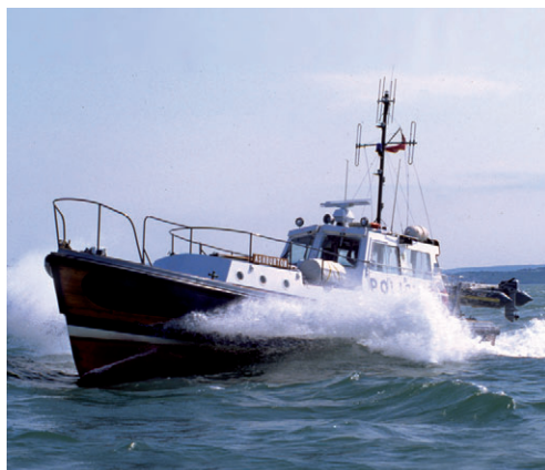
Корпус переходного типа (Nelson), Прекрасные морские лодки, но очень влажные.
