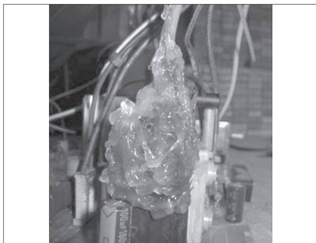
«Ледяная» гора из пластика на корпусе ТДКС
