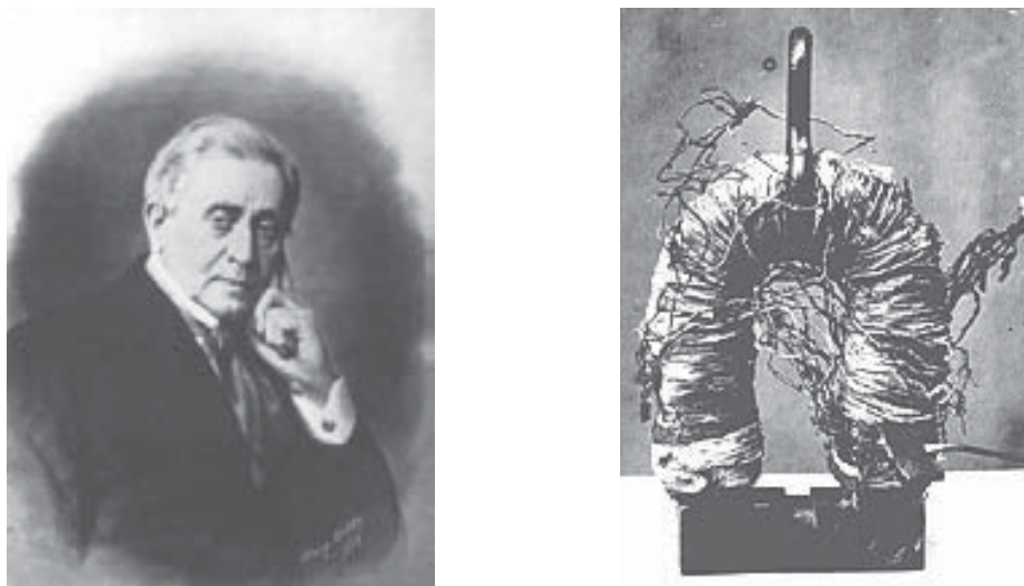
Рис. 1.4. Профессор Джозеф Генри и его первый многовитковый магнит, намотанный проводом, изолированным шелковой нитью
