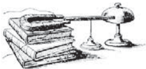
Рис. 1.10. Демонстрационный макет и более поздний образец приемного устройства телеграфа, построенного Генри в 1831 г.
