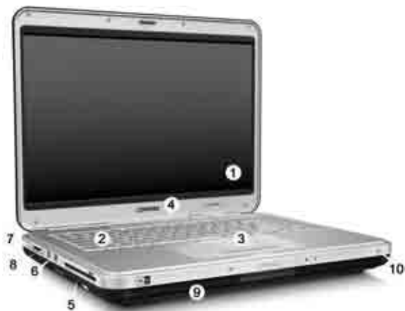
Рис. 1.1. Внешний вид и устройство ноутбука: 1 — экран; 2 — клавиатура; 3 — сенсорная панель (тачпад); 4 — кнопка включения; 5 — оптический привод (DVD-ROM); 6 — порты USB; 7 — кардридер; 8 — гнездо для устройств ExpressCard; 9 — динамик; 10 — кнопка включения адаптера WiFi
