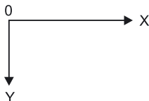
Рис. 1. Расположение и направление экранных осей
