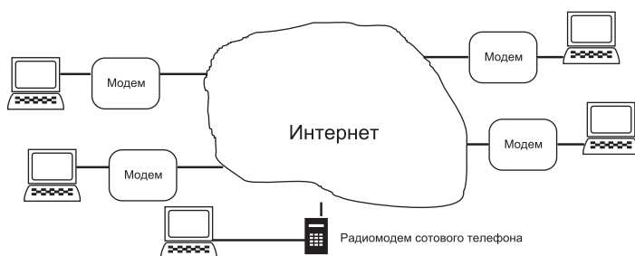
Рис. 2.1. Подключение компьютеров к «облаку Интернета»
