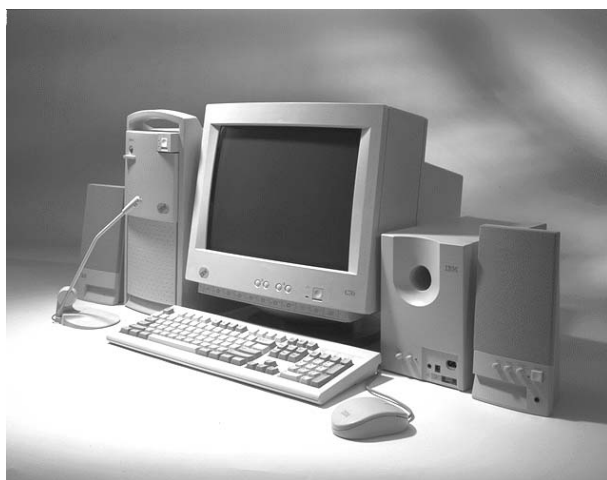
Рис. 2.2. Современный настольный ПК корпорации IBM, оснащенный средствами мультимедиа (CD-ROM-драйв, звуковая карта, микрофон и стереофоническая акустическая система)
