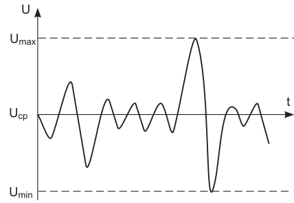
Рис. 1.4. Форма аналогового сигнала ( U_{ср} — «среднее» напряжение, или постоянная составляющая)
