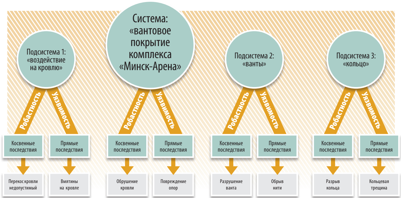
Рис. 2. Характеристика базовой системы «Вантовое покрытие комплекса «Минск-Арена» и инфраструктура подсистем объекта в терминах воздействия, уязвимость, робастность
