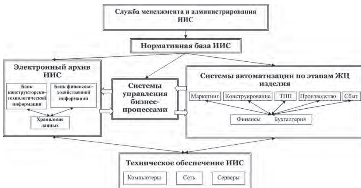
Рис. 1.4. Типовая схема ИИС предприятия
