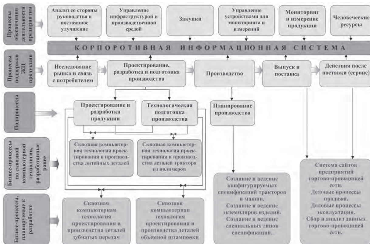
Рис. 1.2. Состав 1-й очереди бизнес-процессов информационной поддержки ЖЦ тракторной продукции
