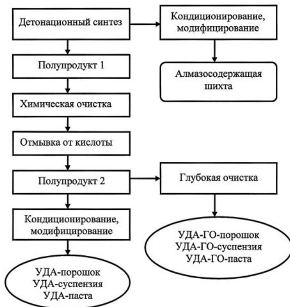
Рис. 1.1. Структурная схема промышленного комплекса по производству УДА
