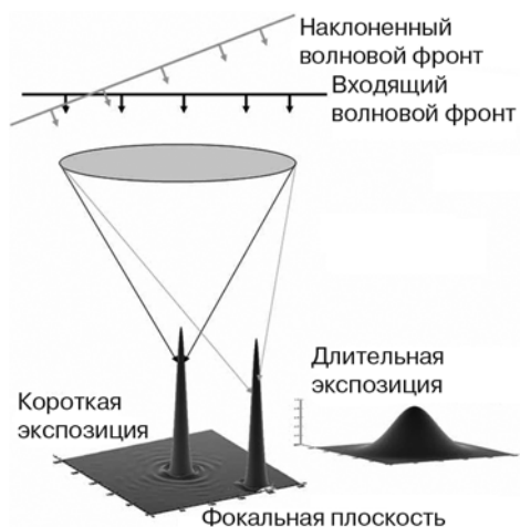
Рис. 1.1. При короткой экспозиции в результате наклона волнового фронта смещается точка фокусировки излучения в фокальной плоскости. При длительной экспозиции профиль интенсивности расплывается
