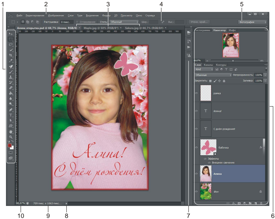
Рис. 1.1. Рабочая среда Adobe Photoshop CS6 (платформа MS Windows) в темно-сером цвете: 1 — панель инструментов; 2 — строка меню; 3 — вкладки окон открытых документов; 4 — панель свойств выбранного инструмента; 5 — переключатель между рабочими средами; 6 — развернутые палитры; 7 — пиктограммы свернутых палитр; 8 — выбор параметра документа для отображения в строке состояния, по умолчанию содержит объем файла; 9 — отображение выбранного параметра документа, в примере отображен размер документа; 10 — масштаб
