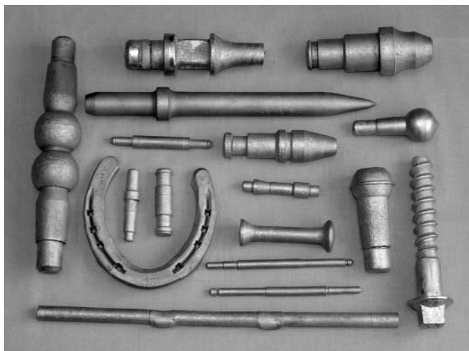
Рис. 1.2. Поковки, полученные методом ПКП по технологиям ФТИ НАН Беларуси
