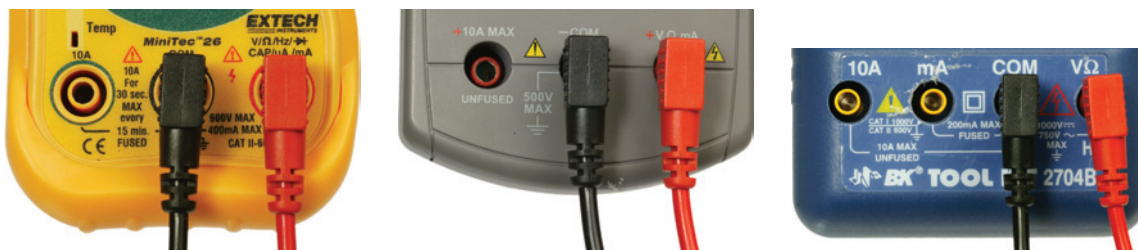
Рис. 1.18. Чтобы измерить сопротивление и напряжение, нужно вставить черный измерительный провод в гнездо «COM», а красный в гнездо «V». Почти все мультиметры имеют отдельное гнездо, в которое вставляют красный измерительный провод только при необходимости выполнить измерение силы тока большой величины в амперах, но мы познакомимся с этой процедурой позднее
