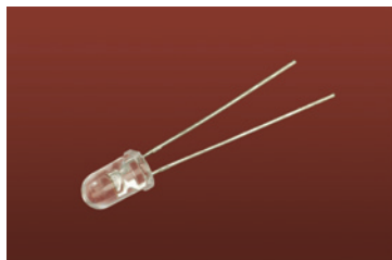
Рис. 1.14. Типичный светодиод диаметром 5 мм
