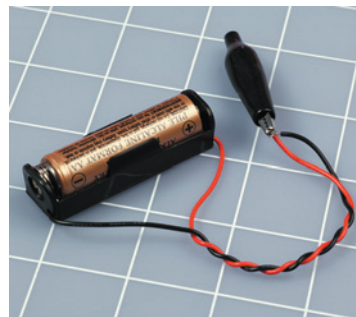
Рис. 1.28. Замыкание щелочной батарейки может быть безопасным, если вы будете точно следовать приведенным далее указаниям. Даже в этом случае батарейка может стать слишком горячей, что касание к ней может вызвать неприятные ощущения. Обращаю ваше внимание на то, что в эксперименте не следует использовать аккумуляторы любого типа!
