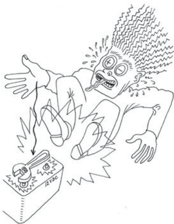
Рис. 1.26. Всякий, кто ронял разводной ключ на оголенные клеммы аккумуляторной батареи автомобиля, скажет вам, что короткое замыкание может быть даже очень мощным при «всего лишь» 12 В
