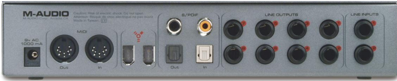
Рис. 1.4. Модуль сопряжения M-Audio FireWire 410 имеет на задней панели разъемы MIDI In и MIDI Out и подключается к компьютеру посредством порта IEEE 1394 (FireWire)
