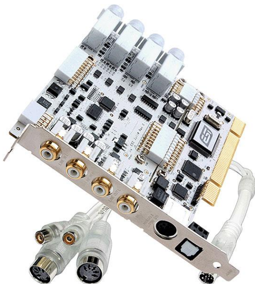
Рис. 1.3. Звуковая карта ESI Juli@ имеет кабель-переходник с разъемами MIDI In и MIDI Out
