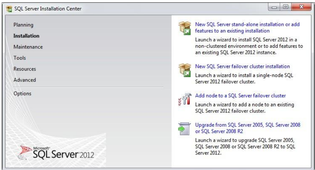
Рис. 1.4. Основное окно инсталляции. Вкладка Installation
