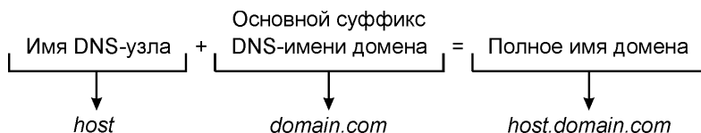
Рис. 1.2. Схема образования полного доменного имени (FQDN)
