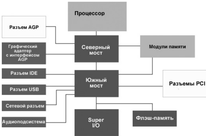
Рис. 1.2. Так выглядит структура персонального компьютера
