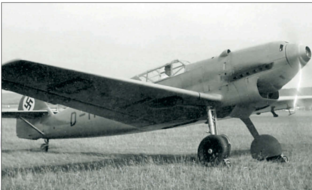
Прототип Bf 109V1 с мотором Jumo 210Ga и воздухозаборником маслорадиатора под мотором
