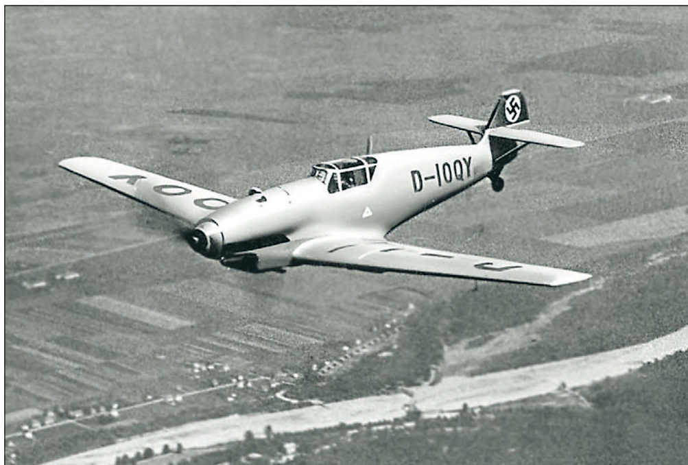
Прототип Vf 109V1 с мотором Jumo 210A
