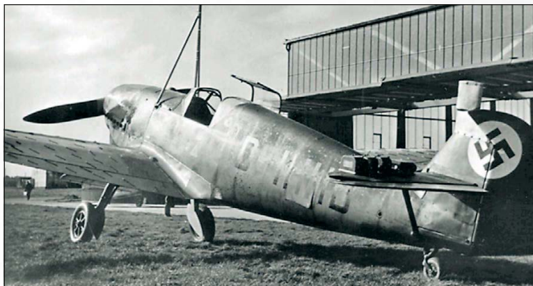
Прототип Vf 109V6 использовался для изучения аэродинамических особенностей машины. На крыло наклеены ленточки, над капотом — мачта с приемником воздушного давления
