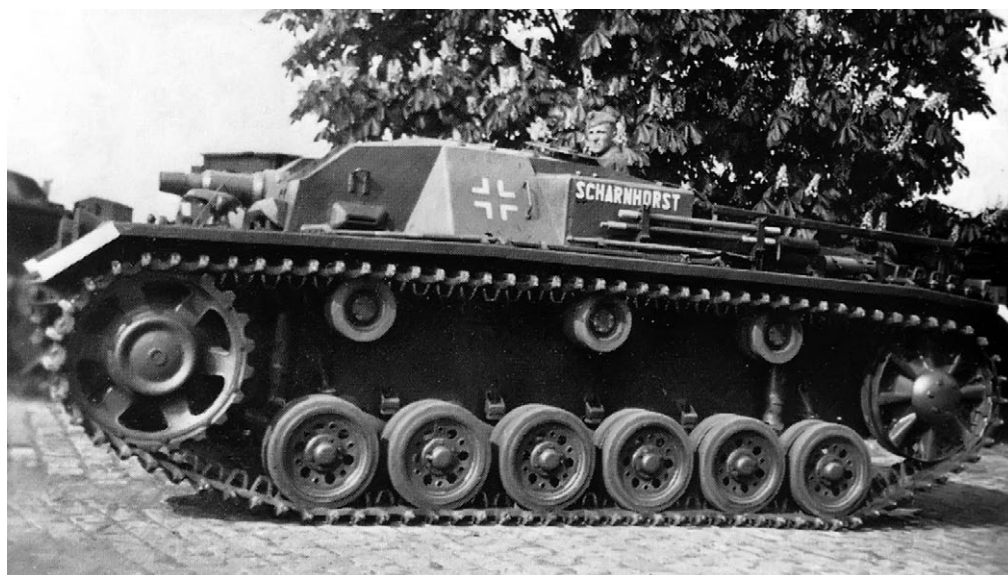
StuG III Ausf. B из состава 201-го диви- зиона штурмовых орудий. Машина про- межуточной модели, с новым ведущим и старым направляю- щим колесом
