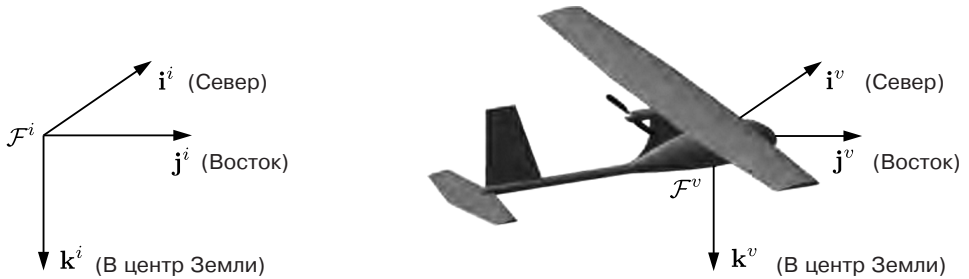
Рис. 2.4. Система координат летательного аппарата. Ось i^v нацелена на север, ось j^v — на восток, а ось k^v направлена к центру Земли
