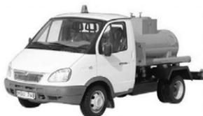
Базовое шасси ..... ГАЗ-3302, 4x2
