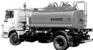
Базовое шасси.....КамАЗ-4308, 4х2
