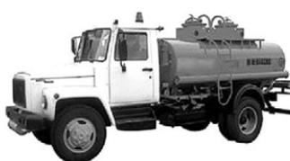
Базовое шасси.....ГАЗ-3307, 4х2
