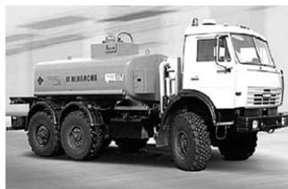
Базовое шасси.....КамАЗ-43101, 6х6
