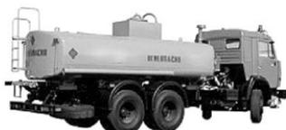
Базовое шасси.....КамАЗ-53215-1964-15, 6x4
