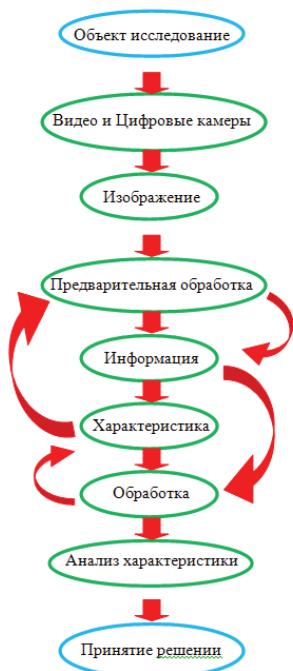
Рис. 5. Схема 2. Алгоритм обработки изображений с целью выделения текстовой информации
