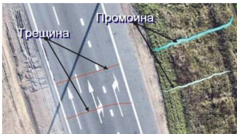
Рисунок 1.9 – Карта поперечных дефектов дорожного полотна
