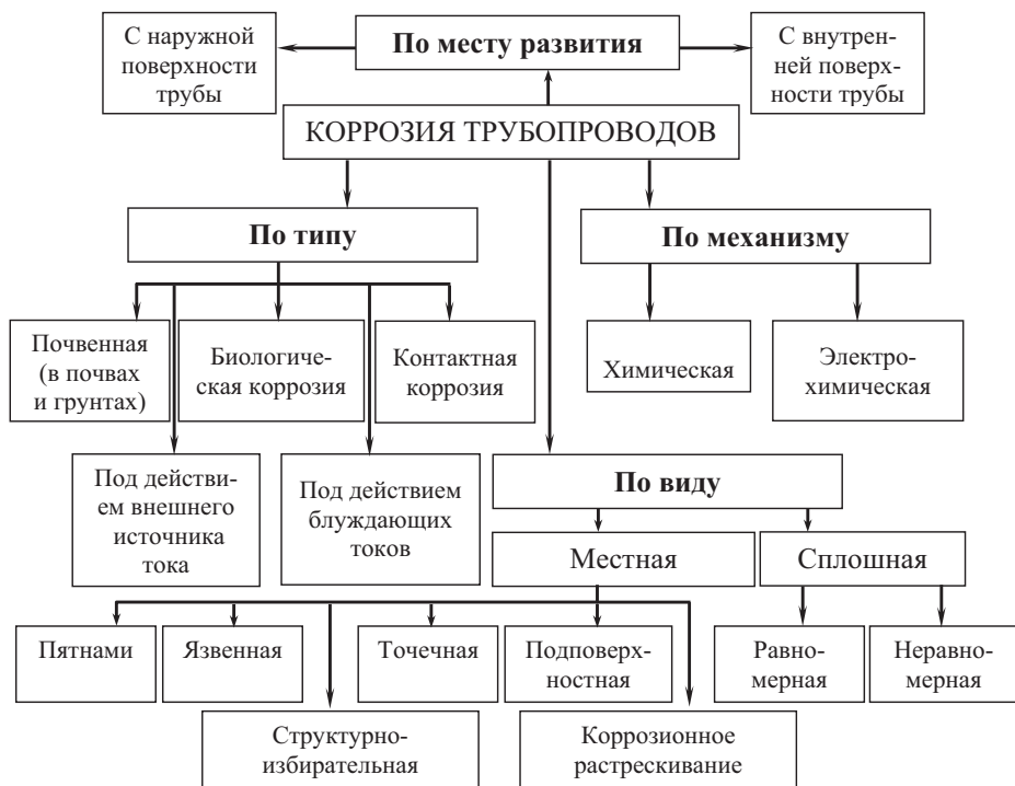
Рис. 1.1. Классификация коррозии трубопроводов
