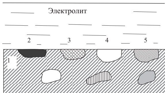
Рис. 1.22. Схема пятиэлектродного коррозионного элемента
