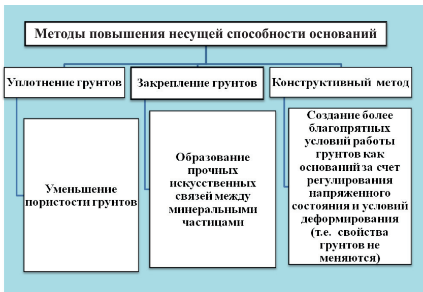
Рис. 2.1. Основные методы повышения несущей способности грунтов оснований
