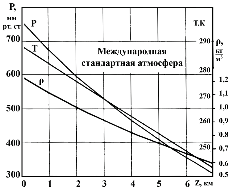
Рисунок 8 - Изменение давления, температуры и плотности по высоте атмосферы
