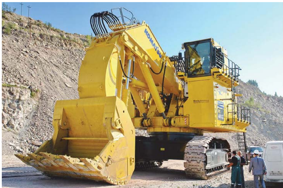
Рис. 2.5. Гидравлический экскаватор типа «прямая лопата» Komatsu PC 4000
