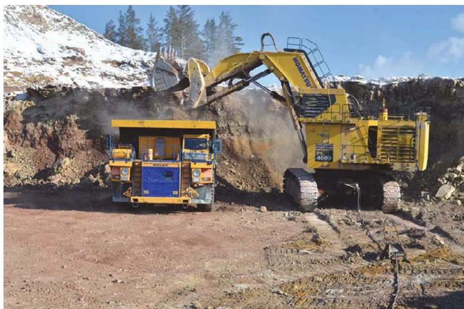
Рис. 2.7. Экскаватор Komatsu PC 4000 в работе
