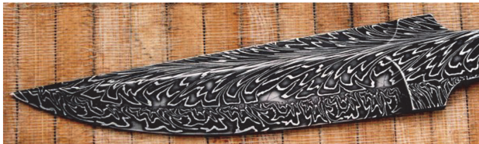
Рис. 1.1. Рисунок на клинке из дамасской стали
