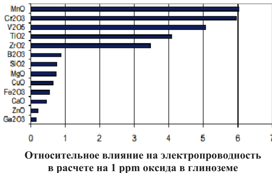
Рис. 1.1. Влияние металлических примесей на электропроводность алюминия в пересчете на соответствующие оксиды, находящиеся в глиноземе [3]
