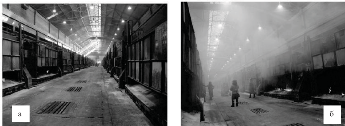
Рис. 1.6. Цех электролизеров с анодами Содерберга, использующий глинозем с содержанием фракции –45 мкм: а – менее 10 %; б – 30 % [19]
