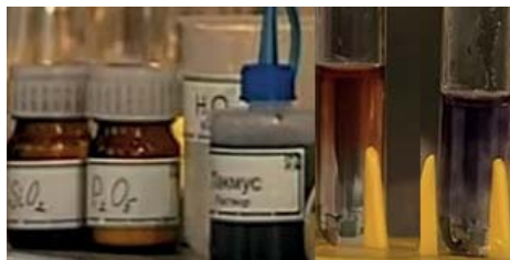
Рис. 1.7. Растворение кислотных оксидов в воде
