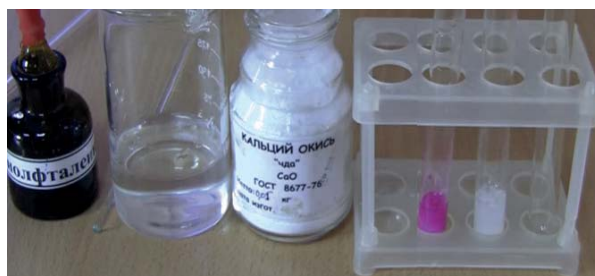
Рис. 1.6. Взаимодействие оксида кальция с водой
