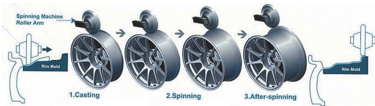
Рис. 1.8. Диски, полученные по технологии Flow Forming [21]
