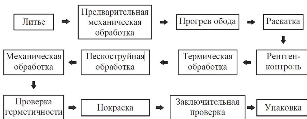
Рис. 1.4. Технология литья с раскаткой обода [2, 3, 15]
