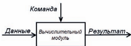
Рис. 2. Вычислительная система класса ОКОД (SISD)
