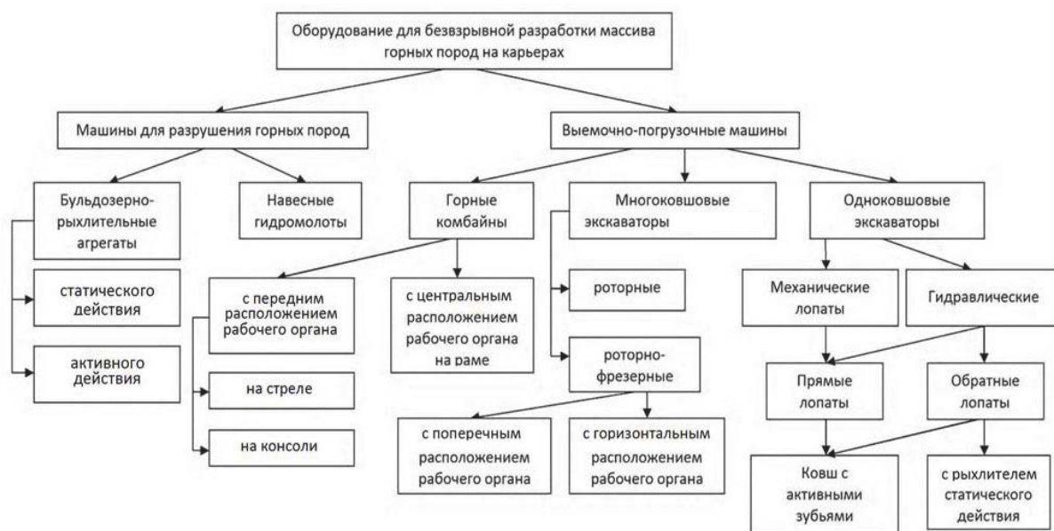
Рис. 1.5. Оборудование для безвзрывной разработки массива горных пород на карьерах [11]
