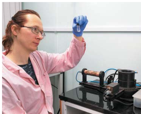
Научный сотрудник Алексей Япрынцев анализирует размеры наночастиц диоксида церия в коллоидных растворах с использованием метода динамического светорассеяния.
