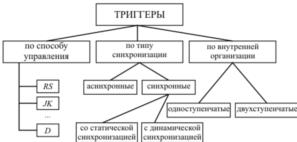
Рис. 1.1.6. Классификация триггерных схем
