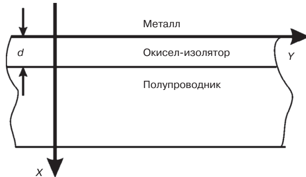
Рис. 1.1. Эскиз типовой МОП-структуры
