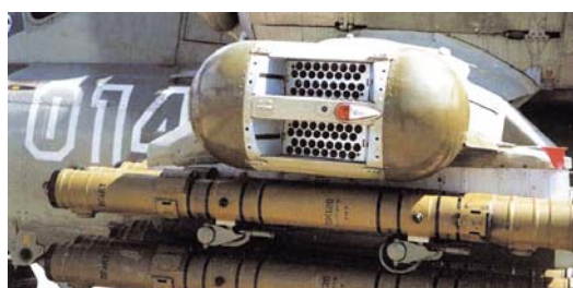
↓ В контейнерах на концах крыла вертолета смонтированы автоматы для сбрасывания тепловых ловушек.
