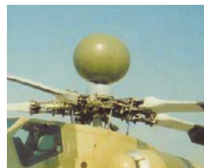
Надвтулочная бортовая РЛС «Арбалет» установлена в обтекатель несущего винта и выдает информацию о препятствиях на маршруте полета.
