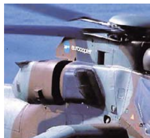
Двигатели вертолета снабжены устройствами для уменьшения его заметности в инфракрасном диапазоне.
