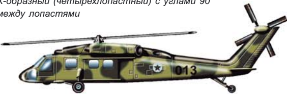
X-образный (четырёхлопастный) с разновеликими углами между лопастями
