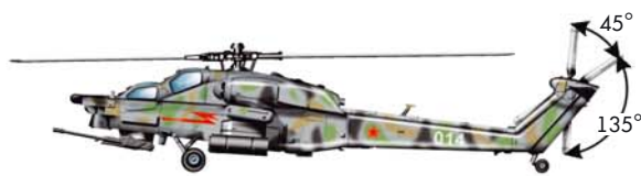
X-образный (четырёхлопастный) с разновеликими углами между лопастями
