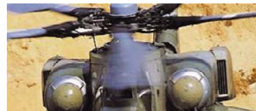
↓ В контейнерах на концах крыла вертолета смонтированы автоматы для сбрасывания тепловых ловушек.
