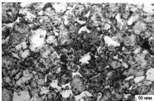
Рис. 1.2.1. Микроструктура порошковой стали ПК10Д5, спеченной при температуре 1150 °С
