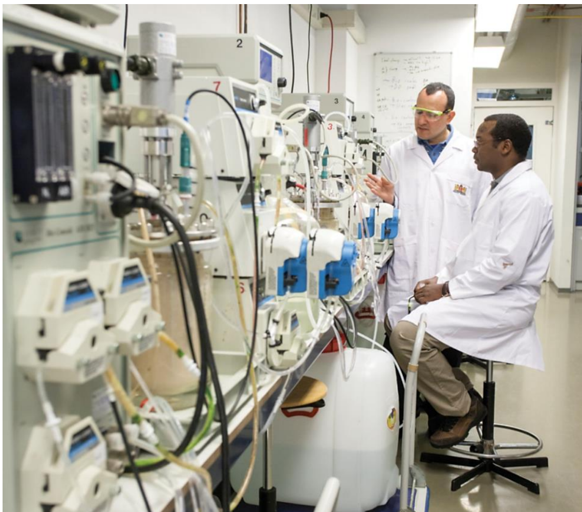
Рисунок 2.1.1. Экспериментальные установки для тестирования активности активного ила в Институте Делфта по образованию в области водных ресурсов при партнерстве с ЮНЕСКО в Нидерландах (фото: IHE Delft)
