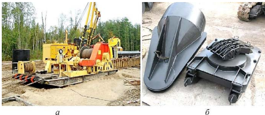
Рис. 1.7. Тяговое средство для протягивания трубопроводов: а – тяговая лебедка ЛП152; б – оголовок и обойма полиспастная
