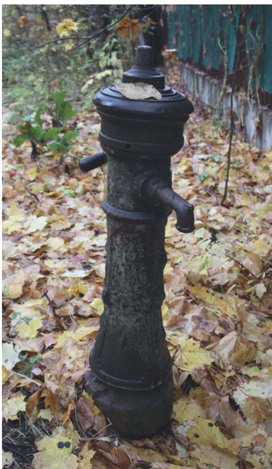
Чугунная литая водоразборная колонка
