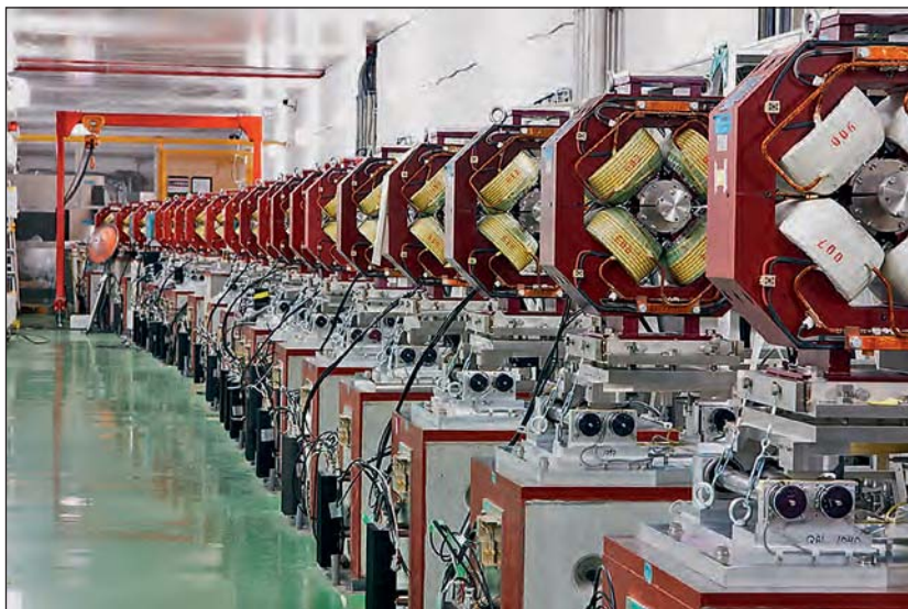
Квадруполь окончательной фокусировки. Фото: КЕК.
