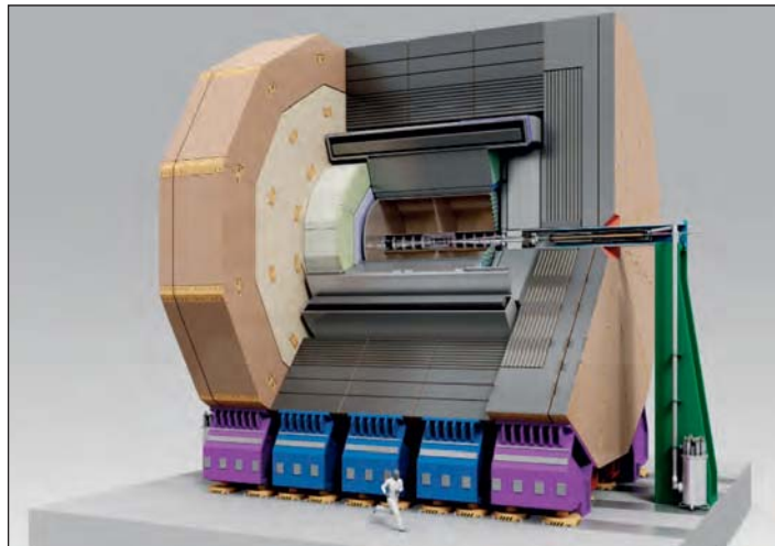
Концепт детектора ILD в разрезе (компьютерная графика). Точка взаимодействия пучков находится в центре. Иллюстрация: Rey. Hori/KEK.
