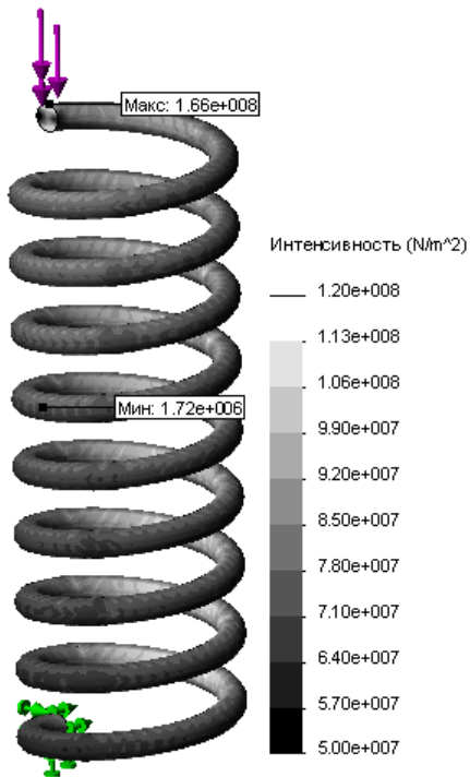
Рис. 1.14. Интенсивность напряжений — суженный диапазон шкалы
