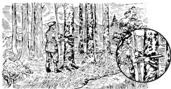
Рис. 19. Измерение диаметра дерева «мерной вилкой»
