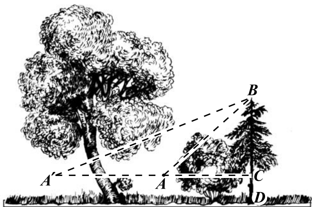
Рис. 13. Как измерить высоту дерева, не приближаясь к нему
