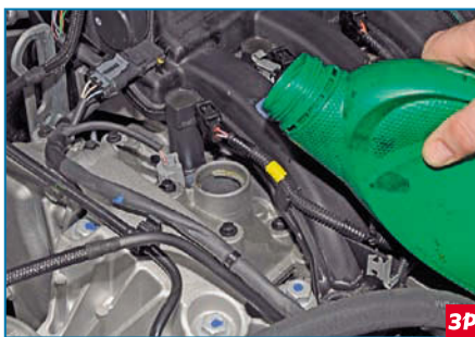
Через горловину доливаем масло в двигатель небольшими порциями.
