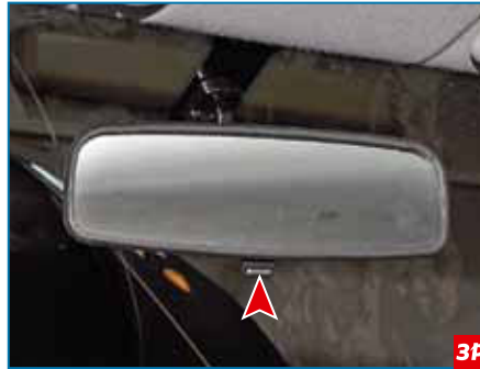
Внутреннее зеркало заднего вида с регулятором положения «день» и «ночь».
